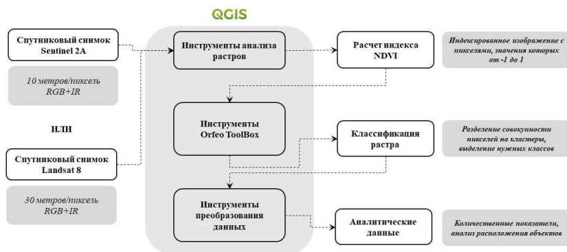
Рис. 2. Блок-схема общего алгоритма методики автоматизированной классификации данных ДЗЗ
